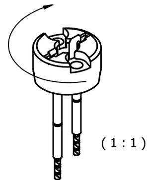
Nach dem Einsetzen: Lampe nach rechts drehen bis zum Anschlag (ca. 45°)
